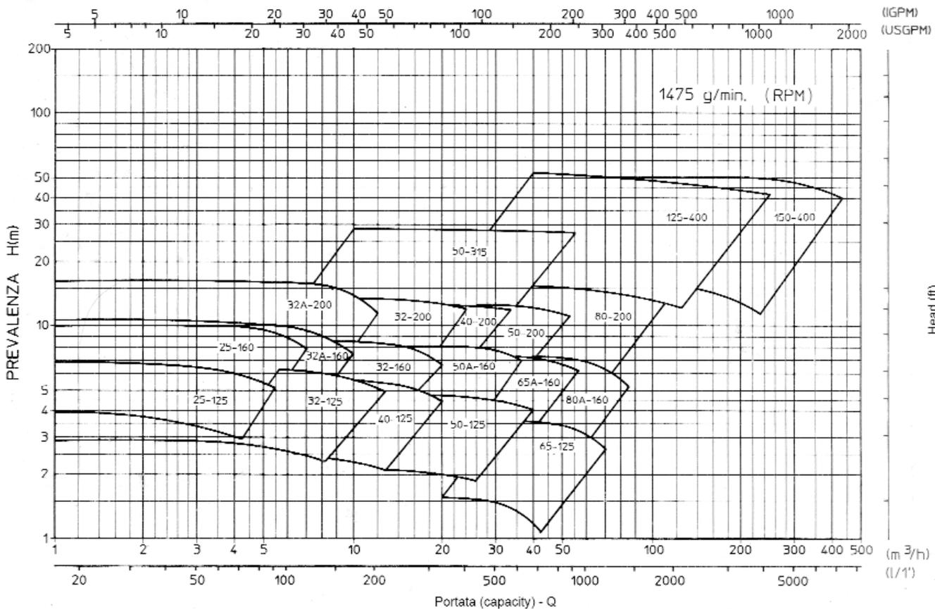
I dati di funzionamento devono essere rilevati dalle singole curve di collaudo. Per impieghi a numero di giri diverso, consultare il ns Ufficio Tecnico.
